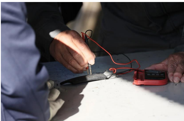
まず炭の抵抗を測ります。100Ω以下でないと電池極になりません
